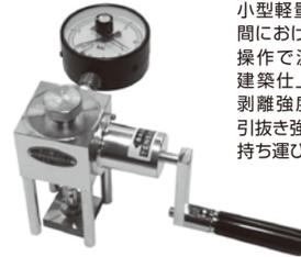
小型軽量の引張り試験器で、二層間における試料の接着力を簡単な操作で測定出来ます。モルタル、建築仕上げ塗材、小形タイル等の剥離強度や外壁補修用ピン等の引抜き強度検査にも使用出来ます。持ち運びに便利な携帯用ケース付。
